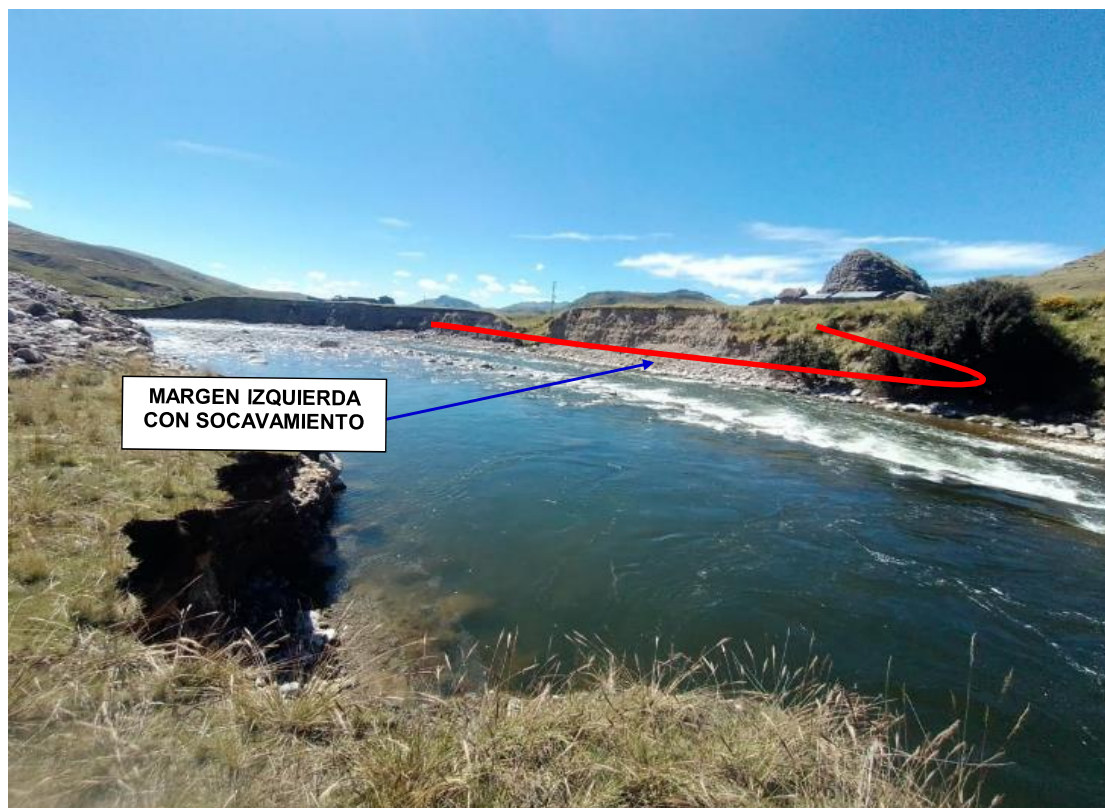
FIGURA N° 02: RIO VELILLE EXPUESTO ANTE SOCAVAMIENTO POR LA MARGEN DERECHA CON COLAPSO DE TALUD.
